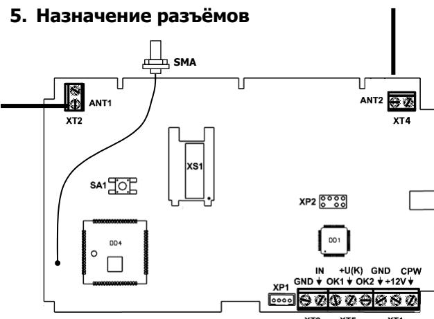
**XP1** – разъём для подключения кабеля для связи с компьютером.
